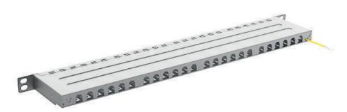
Verteilerfeld für den Einbau in 19"-Befestigungsraster. Einbauhöhe 0,5HE. Frontblende mit 24 ausgestanzten Keystonelochungen zur Aufnahme der Fairline Module. Aufgedruckte Portnummerierung und Beschriftungsfelder. Abnehmbare Kabelabfangung.
