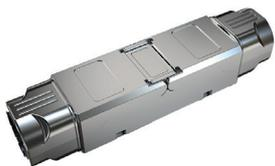
S/FTP Kabelverbinder der Kategorie 6<sub>A</sub> gem EN 60603-7-51 zur Verlängerung oder Reparatur bestehender Installationsstrecken. Korrekte 1:1 Durchverkabelung gewährleistet durch Führung auf den Kabelmanagern. Wieder zu öffnendes, metallisches Gehäuse.
