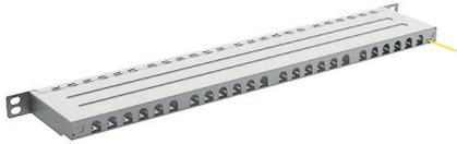
Verteilerfeld für den Einbau in 19"-Befestigungsrastrer. Einbauhöhe 0,5HE. Frontblende mit 24 ausgestanzten Keystone-Lochungen zur Aufnahme der Fairline Module. Aufgedruckte Portnummerierung und Beschriftungsfelder. Abnehmbare Kabelabfangung.
